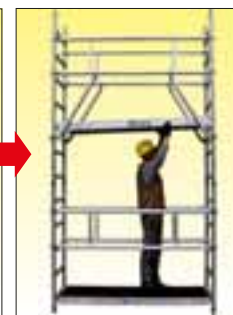
Installa la piattaforma superiore all'ultimo piolo e sali attraverso la botola
