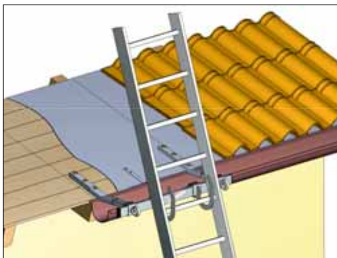
Balestra regolabile di ancoraggio su superficie dritta e/o piana
