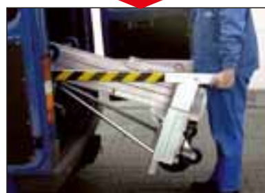
E' possibile ripiegare le barre di sostegno mediante dispositivo con sblocco rapido senza l'ausilio di utensili per consentirne il trasporto anche su piccoli automezzi.
