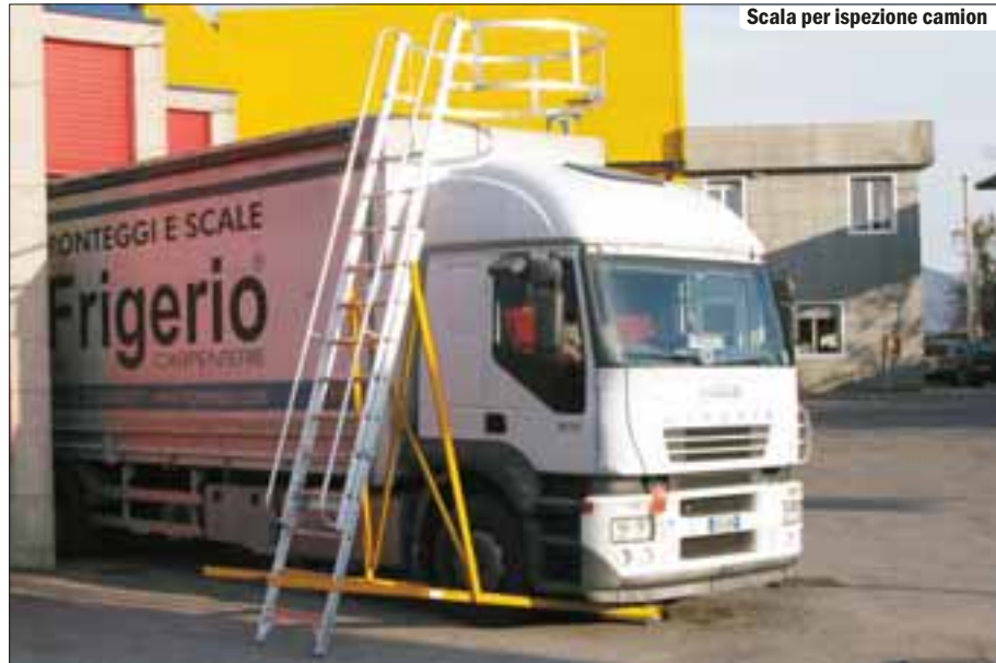
Scala piattaforma ecologica con gradini in grigliato
