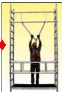
Aggancia il parapetto superiore usando i tiranti come prolunga
