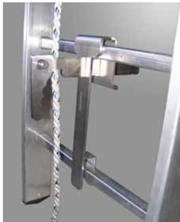
Dispositivo di fissaggio inferiore in piastra pressopiegata di sp. 2 mm. provvisto di tenditore fune a regolazione manuale
