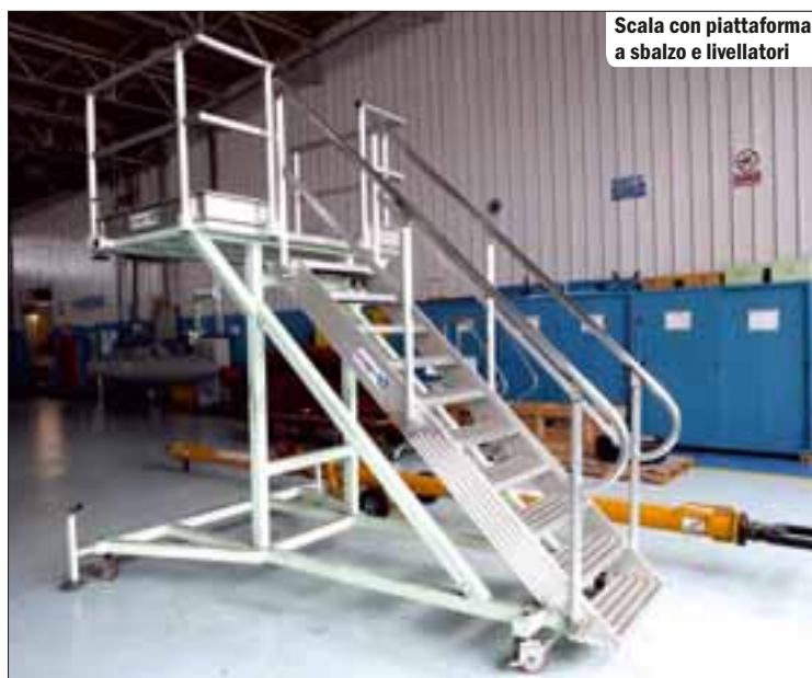
Sgabello speciale con ruote auto-disattivanti
