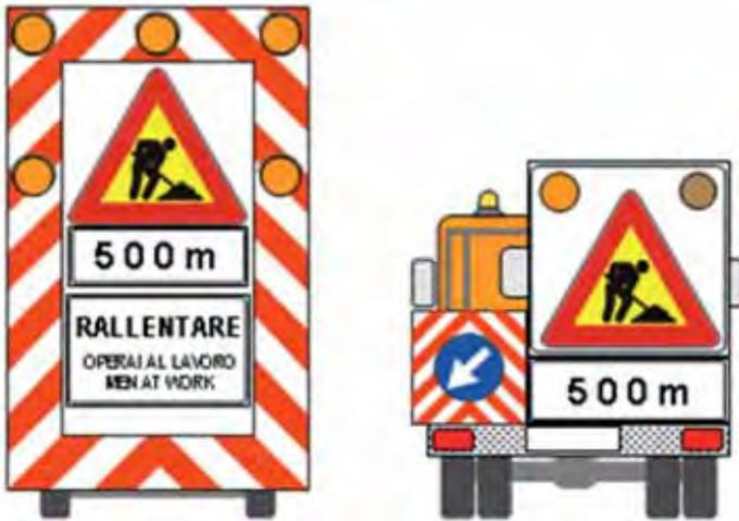
Esempi di presegnalazione di cantiere mobile in corsia di emergenza, il pannello segnaletico con appendice distanziometrica deve in ogni caso contenere un triangolo “lavori in corso” con lato 120 cm. e, nel caso dell’autocarro, essere integrato con lampade led M200 gialle omologate cl. L8H e certificate “CE” ad elevata efficienza.
