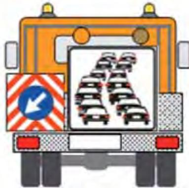
Esempio di cartello e autocarro utilizzabili per la presegnalazione di code o rallentamenti (in alternativa al mezzo dotato di PMV full color). Il pannello “code” deve avere dimensioni non inferiori a 90x90 cm. e il cartello Fig. Il 398 Art. 38 (90x90) sul carrello, va obbligatoriamente applicato contestualmente al suo posizionamento.
