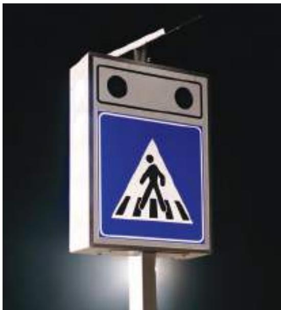
Tutte le luci entrano in funzione solo in caso di attraversamento mediante un pulsante di chiamata. Un sistema radio di sincronizzazione consente l'accensione simultanea di entrambi i segnali posti ai lati della carreggiata. In aggiunta, se le condizioni di installazione lo consentono, è possibile integrare il sistema con un sensore a doppia tecnologia per la rilevazione automatica del pedone.
