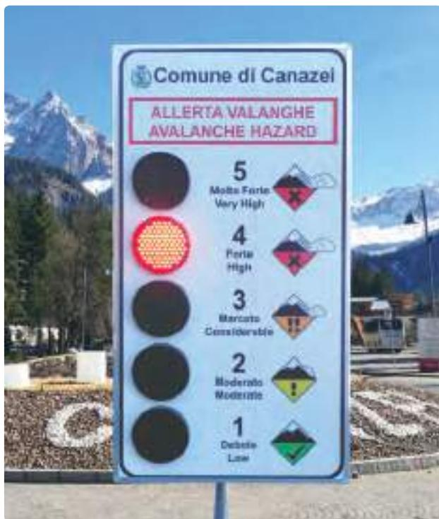
Il sistema può essere alimentato da rete elettrica, da rete pubblica o da kit fotovoltaico (compatibilmente con il luogo di installazione). Il pannello è realizzato in alluminio estruso verniciato in polvere epossidica nera ultra opaca, su cui è applicata una pellicola rifrangente cl.1 che riporta i livelli di allerta e il nome del Comune. Il display è integrato nel pannello frontale, in modo da rendere il pannello gradevole dal punto di vista estetico.
