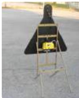
Realizzato in materiale VTR lato 90 cm., rifrangenza cl. 2 prismatica, con lampada multiled 100 omologata cl. L2H e certificata “CE” o led M200 omologata cl. L8H e certificata “CE” a luce rossa fissa per lavori in corso, lampeggiante gialla per altre figure, completo di cavalletto e pacco batterie (batterie escluse).
