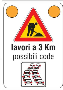
Cartello di preavviso con lampade led ad alta efficienza M200 gialle omologate cl. L8H e certificate “CE”, dimensioni 135x200 cm. Posizionamento sul margine destro su cavalletto a circa 3.000 mt. dal triangolo “lavori in corso”
