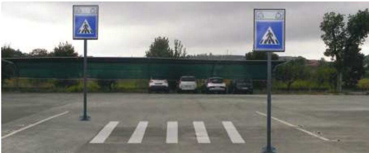
Il sistema viene attivato mediante un pulsante di chiamata pedonale ed una comunicazione radio consente l'accensione simultanea di entrambi i segnali posti ai lati della carreggiata. Trascorso il tempo necessario all'attraversamento, le luci di segnalazione si spengono automaticamente. In aggiunta, se le condizioni di installazione lo consentono, è possibile integrare il sistema con sensore a doppia tecnologia per la rilevazione automatica del pedone.
