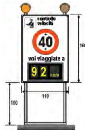
Dissuasore su cavalletto con rivelatore radar di velocità.
