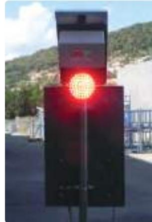
Targa dimensioni 90x135 cm., realizzata in materiale di alluminio scatolato, interamente rifrangente cl.2 prismatica, con nr. 2 lampade multiled 100 gialle lampeggianti, con display di velocità a 3 cifre. Nel retro lampada led M200 rossa che lampeggia al di sopra della velocità consentita, alimentata da kit fotovoltaico, kit di alimentazione rete elettrica o kit di alimentazione rete pubblica.
