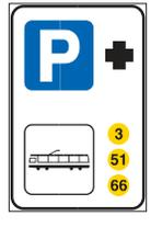
FIG.369 ART.136 PARCHEGGIO DI SCAMBIO CON TRAM
