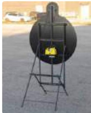
Realizzato in materiale VTR disco Ø 90 cm., rifrangenza cl.2 prismatica, con lampada multiled 100 omologata cl. L2H e certificata “CE” o led M200 omologata cl. L8H e certificata “CE” a luce lampeggiante gialla, completo di cavalletto e pacco batterie (batterie escluse).
