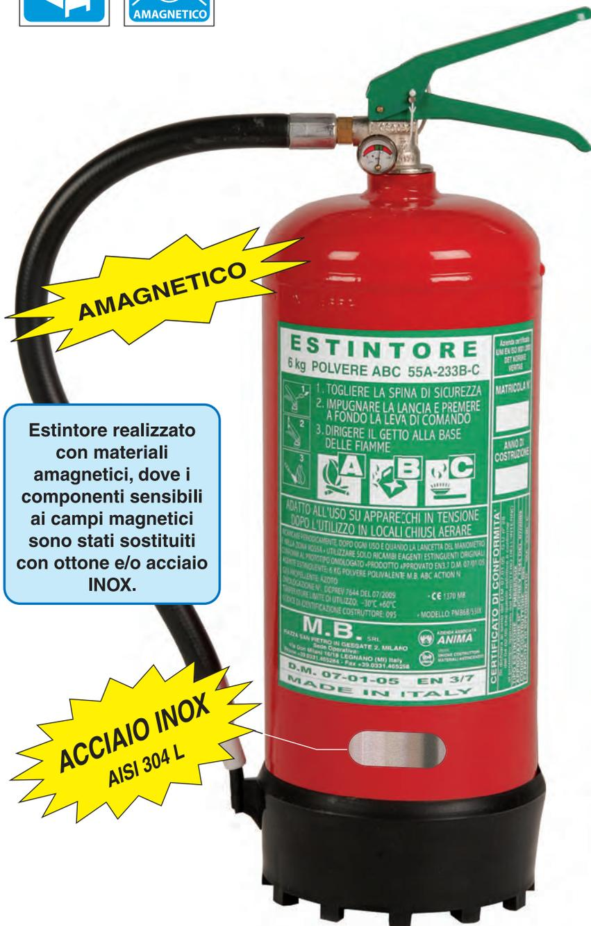
Estintore realizzato con materiali amagnetici, dove i componenti sensibili ai campi magnetici sono stati sostituiti con ottone e/o acciaio INOX.
