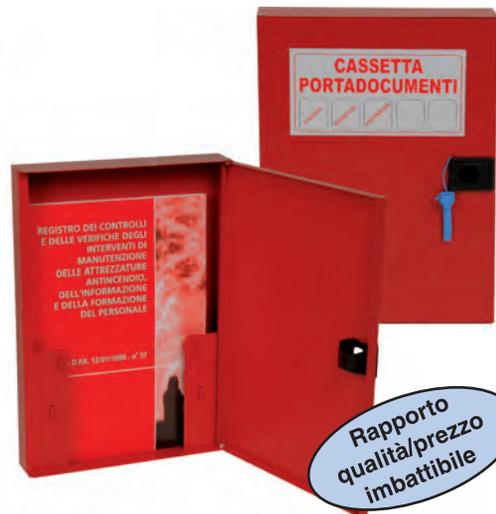
La cassetta è realizzata con lamiera lucida da 10/10, verniciata a base di resine in poliesteri di colore rosso RAL 3000 a norma ISO 9227 con elevata resistenza agli agenti atmosferici. La cassetta è dotata di portello con apertura a 180° e chiusura con predisposizione per sigillo.
