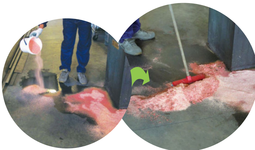
APPLICAZIONE MULTISORB-C SU SVERSAMENTO OLIO MECCANICO IN AMBIENTE INDUSTRIALE.
