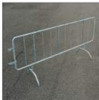
TS250 Transenna tubolare diametro 33 mm, con tondini diametro 12 mm, altezza 1100 mm., lunghezza 2,5 mt. Munita di ganci collegabili tra loro in linea oppure ad angolo.
